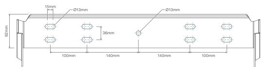
MINIMUM RECOMMENDED FASTENERS PER LUMINAIRE:
