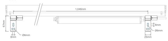
MINIMUM RECOMMENDED FASTENERS PER LUMINAIRE:
